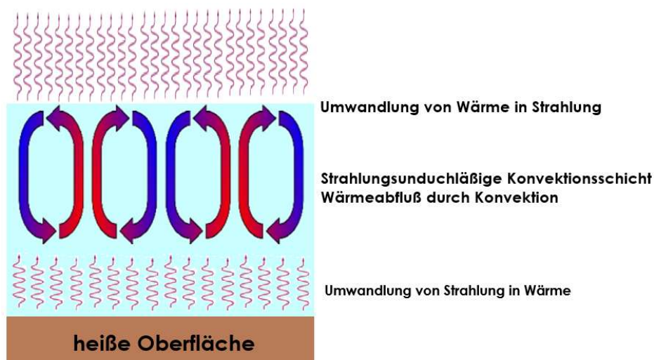
Abbildung 19: In einer konvektiven Atmosphäre muß sich eine für die Treibhausgasfrequenzen undurchlässige Konvektionsschicht ausbilden.
