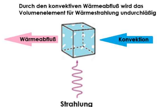
Abbildung 18: Ein Volumenelement in Schwarzschilds Sonnenatmosphärenmodell vs. ein Volumenelement in unserer Troposphäre.
