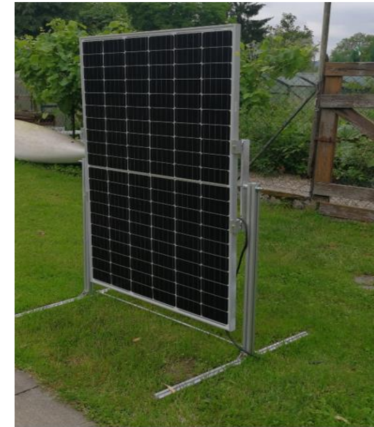
Solarpaneele senkrecht gestellt. Bei Regen, Schneefall od. Hagel
