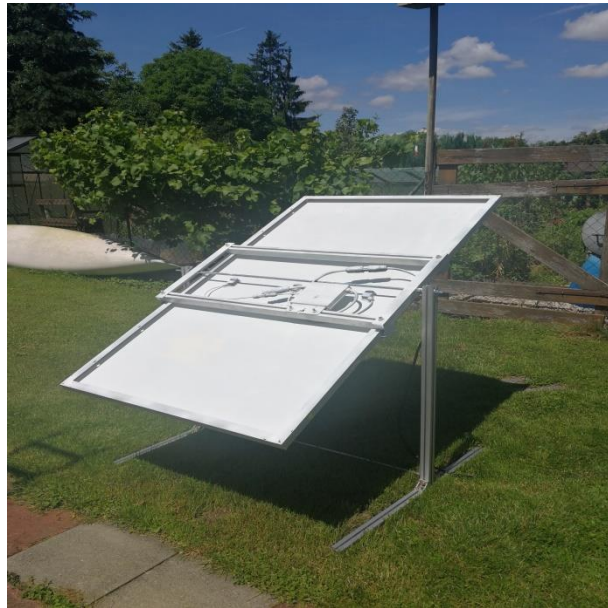
Bei Überstrom wird die Sonnenstrahlung reflektiert
