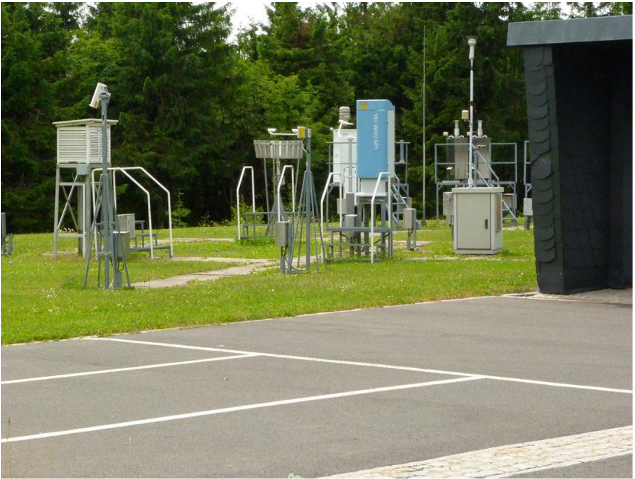
Abbildung 15: Die ländliche, fernab von Siedlungen stehende DWD-Station Schmücke auf dem Kamm des Thüringer Waldes wird durch einen nur wenige Meter entfernten Parkplatz und das Dienstgebäude der DWD-Bürokraten (rechts im Bild der Anbau) erwärmt. Foto: Stefan Kämpfe, Juni 2022
