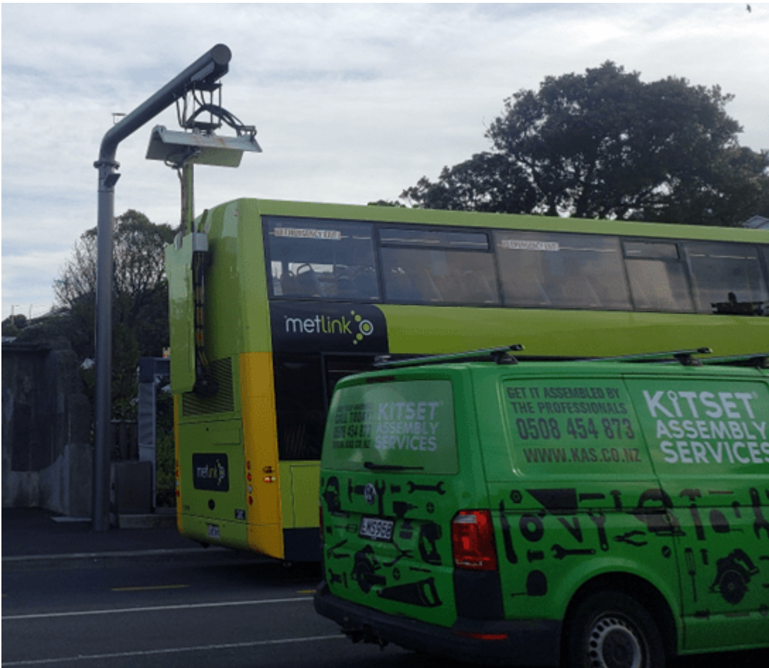
Doppeldecker-Elektrobus mit Stromabnehmer-Aufladung
