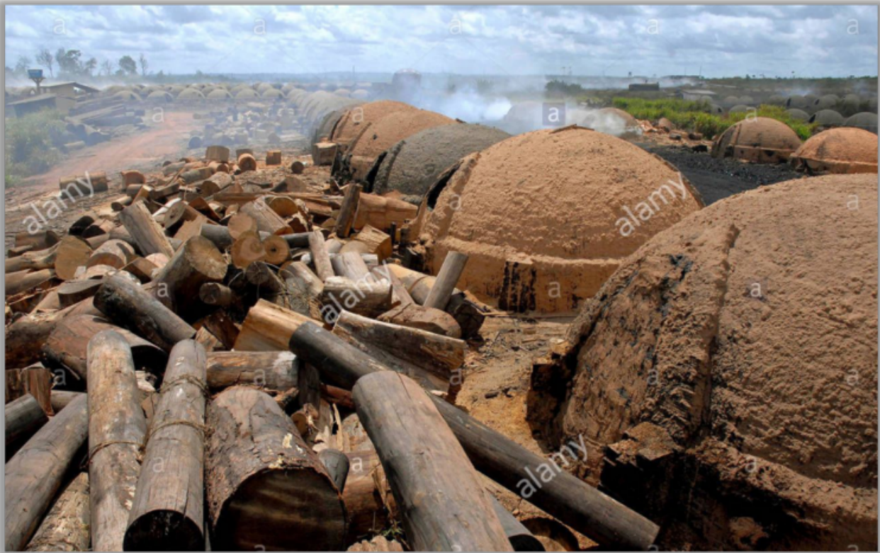
Abbildung 2: „Bienenstock“-Holzkohleöfen in Brasilien. Quelle: Alamy, aus Troszak 2019
