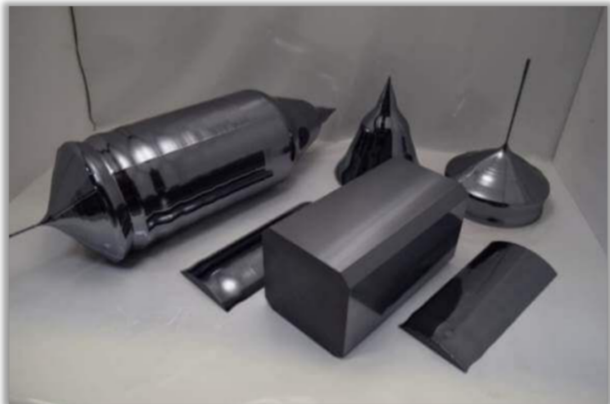
Abbildung 4: Czochralski-Verfahren, ganzer Block (links), Ziegel und Sehen nach dem Sägen (rechts), Krone und Schwanz (oben rechts) Quelle: SVM aus Troszak 2019
