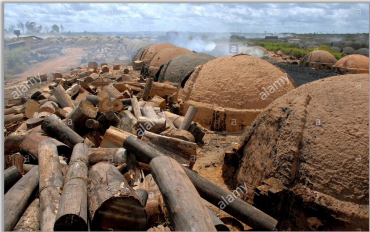
Abbildung 2: „Bienenstock“-Holzkohleöfen in Brasilien. Quelle: Alamy, aus Troszak 2019
