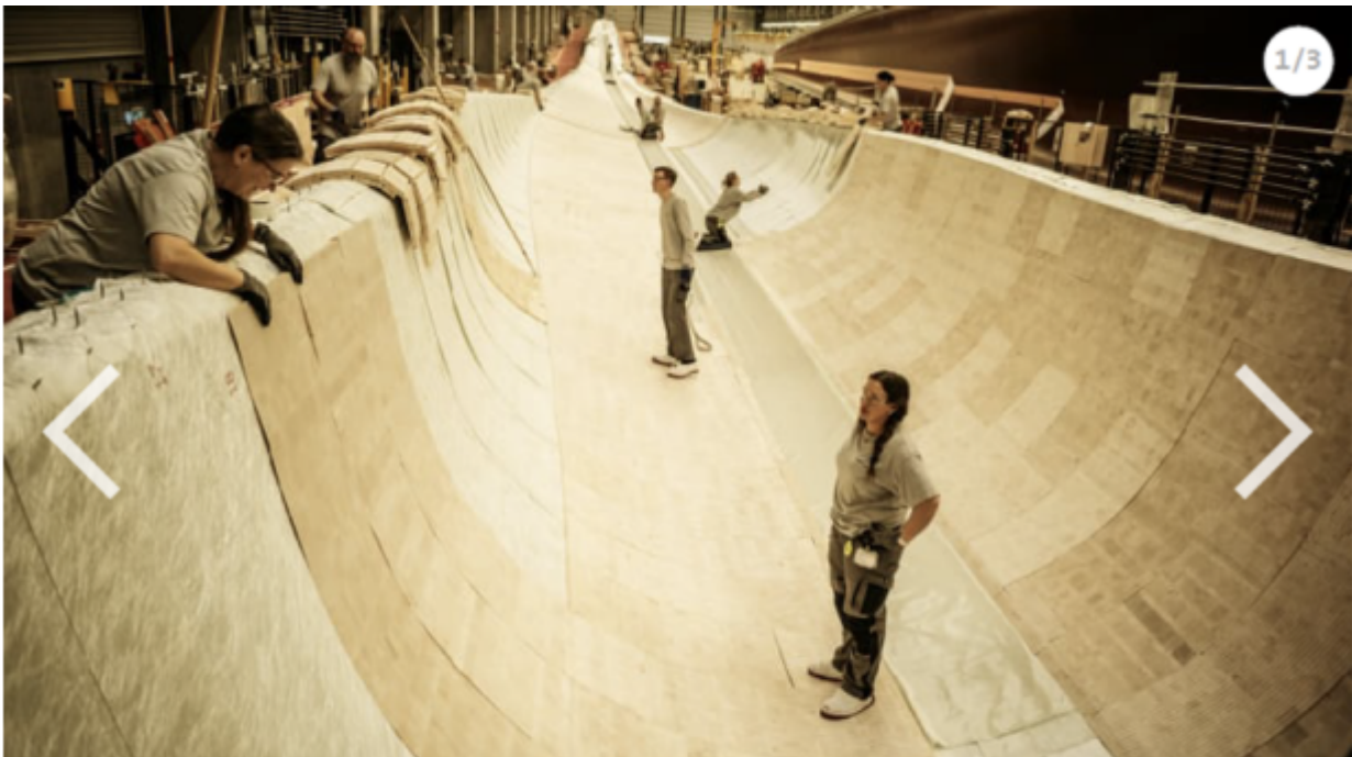
Die Innenseite eines 81 m langen Rotorblatts wird im Februar 2022 in einem Werk von Siemens Gamesa in Dänemark mit Balsa ausgekleidet (© Carsten Snebjerg)
