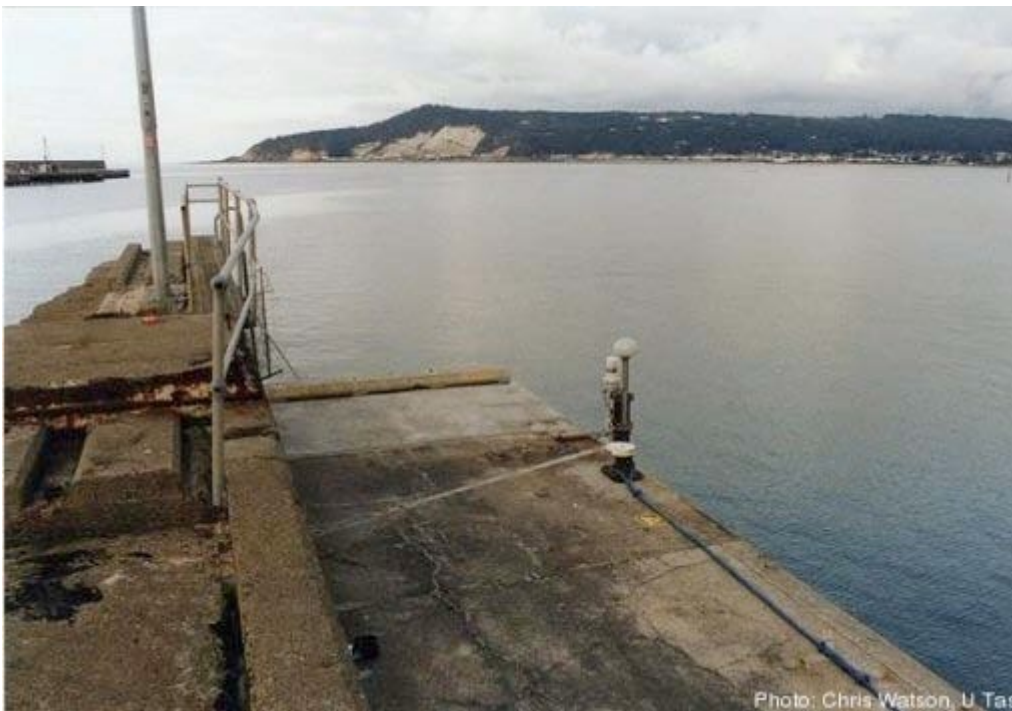
Abbildung 57: Tasmanische Pegelmessstation mit GPS Gerät zur Topex/Poseidon Satelliteneichung [31] Quelle WattsUp. S. Fußnote
