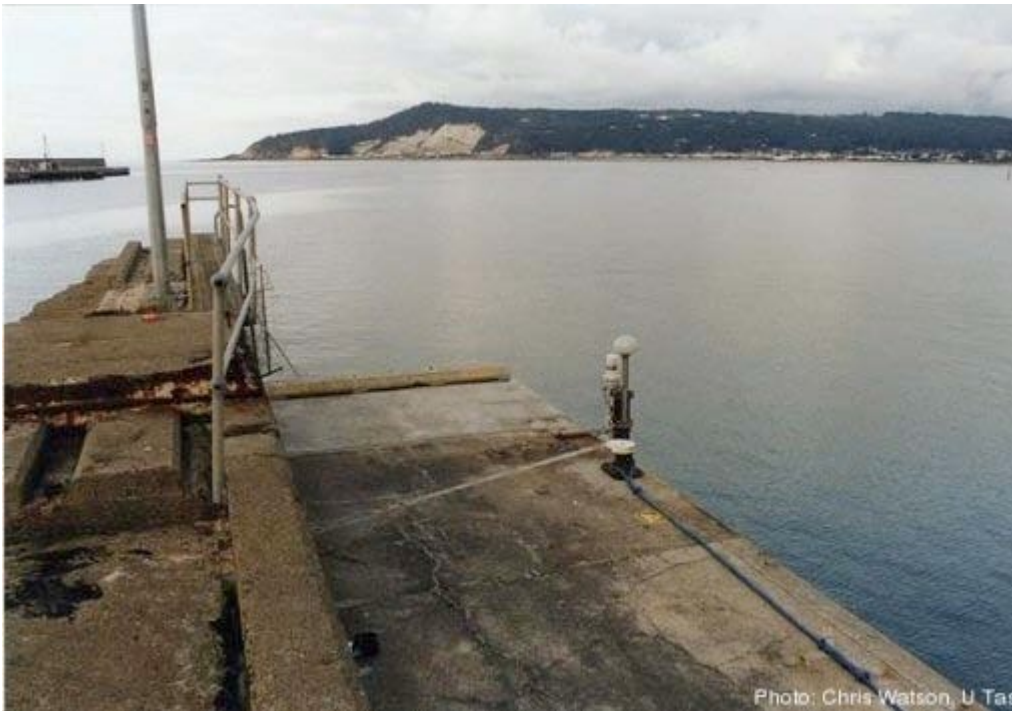
Abbildung 57: Tasmanische Pegelmessstation mit GPS Gerät zur Topex/Poseidon Satelliteneichung [3] Quelle WattsUp. S. Fußnote
