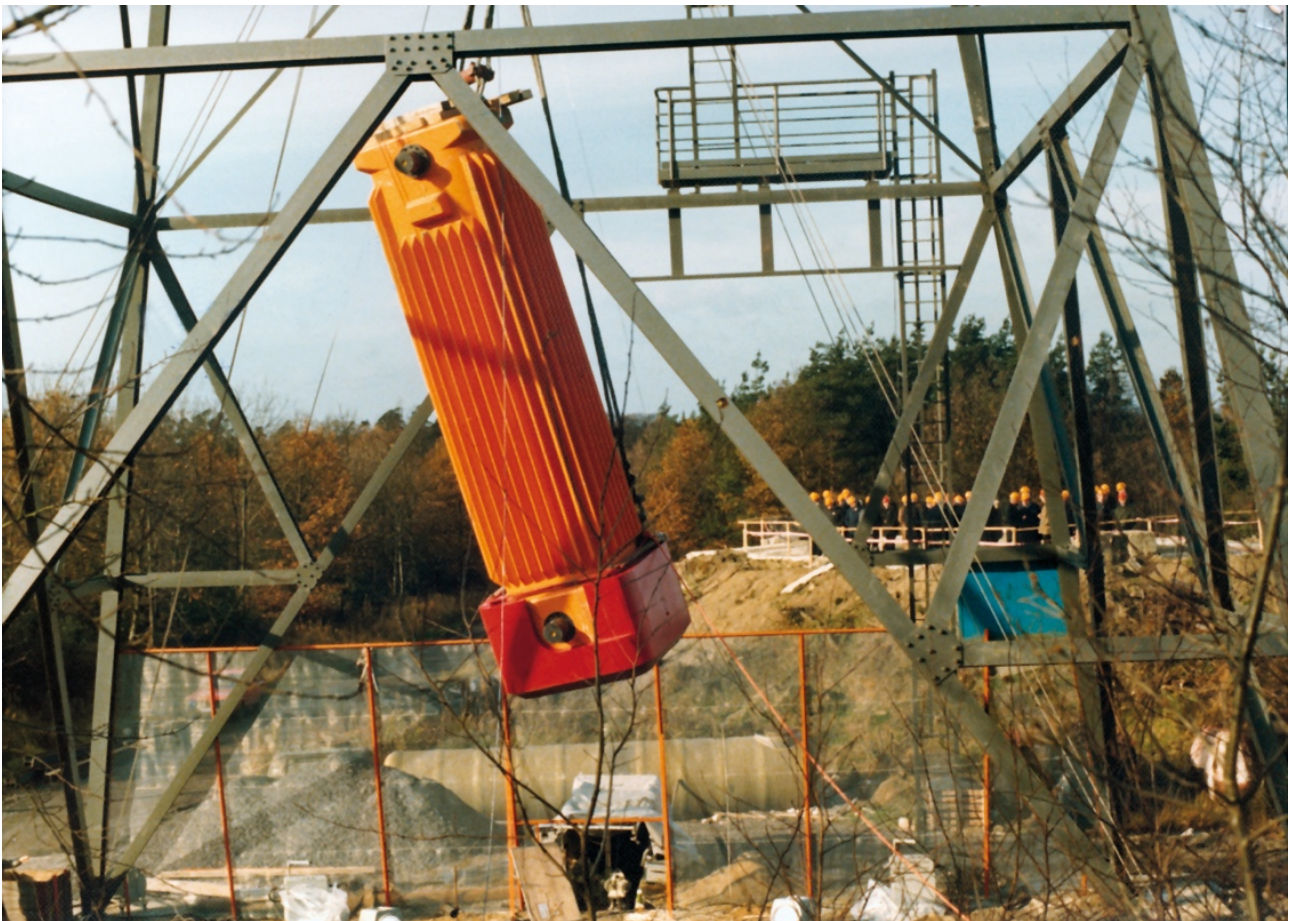
Bild 5: CASTOR Transportbehälter sind eine deutsche Erfindung und unfallsicher. Hier ein BAM-Test im Jahre 1978
