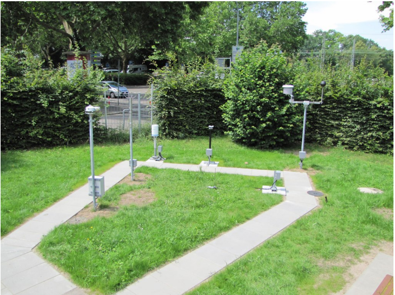
Abb.6b: Die ehemalige Strahlung reflektierende Wetterhütte ist abgeschafft. Die Aufnahme wurde von der rückwärtigen Seite des DWD-Hauses aus in Blickrichtung Garten gemacht. Das Dachrinnenwasser einer Haushälfte könnte in der Mitte der Einzelmessgeräte in eine Versickerungsmulde einfließen. Anstatt dessen steht der Temperatursensor nur mit einer Pilzhäube abgeschirmt in 2m Höhe direkt neben dem Plattenweg, der im Sommer bis 45°C heiß wird und der Rasen braungelb verkümmert ist. Auch der braune Boden wird in trockenen Sommern tagsüber bis zu 40°C heiß. (Eigenmessungen der Autoren) Foto: DWD
