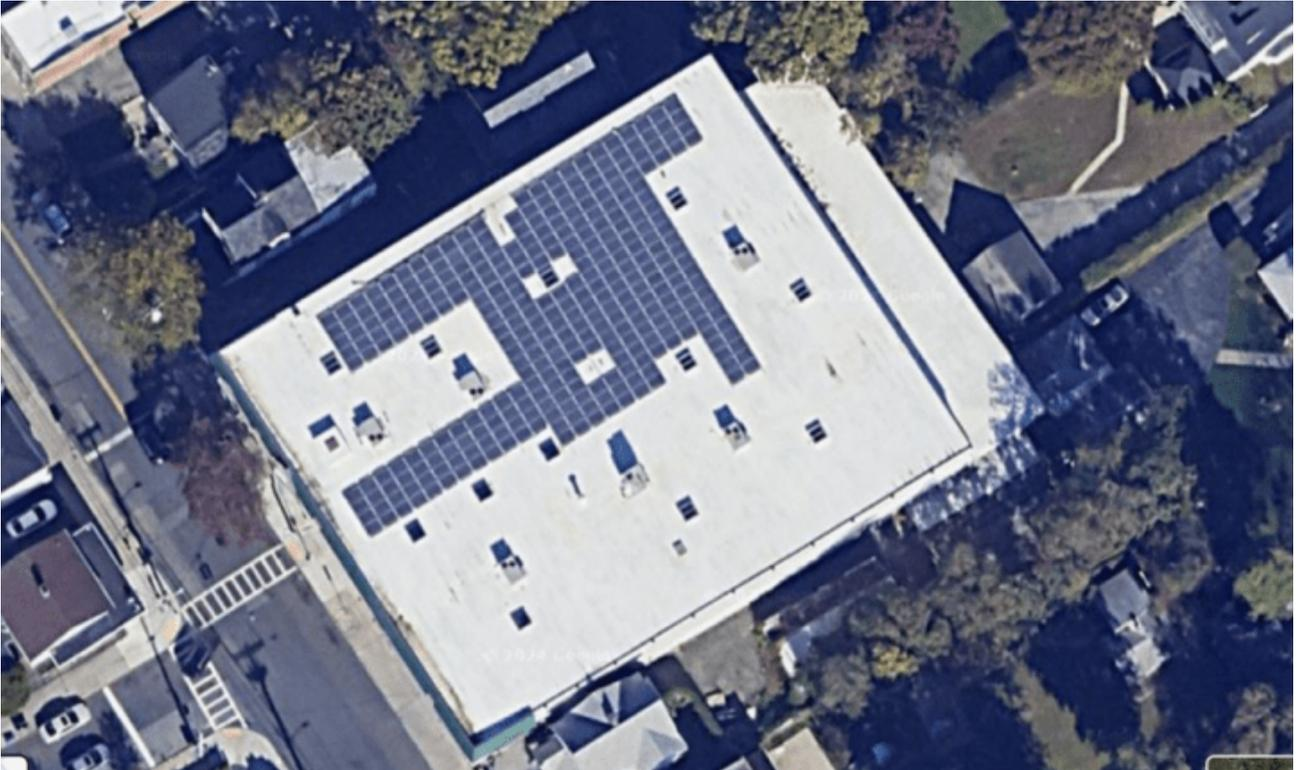
Abbildung 1: Ellenbogen-Fabrik mit einer 50-KW-Solaranlage auf dem Dach in New Rochelle, NY
