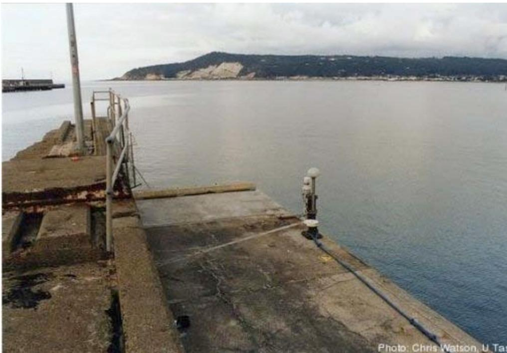
Abbildung 57: Tasmanische Pegelmessstation mit GPS Gerät zur Topex/Poseidon Satelliteneichung<sup>[31]</sup> Quelle WattsUp. S. Fußnote
