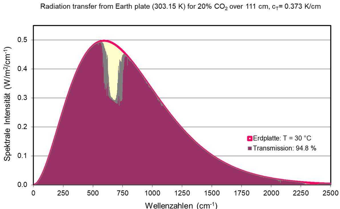
Abb. 2: Strahlungs-Transfer-Rechnung für 20 %  $\text{CO}_2$  in trockener Luft über 111 cm bei einem Temperaturgradienten von  $-0,373 \text{ °C/cm}$ . Schwarzkörperstrahlung der Platte  $P_E$  ( $T_E = 30 \text{ °C}$ ) (Rot Gelb), durchgelassene spektrale Intensität (Dunkelrot u. Grau).
