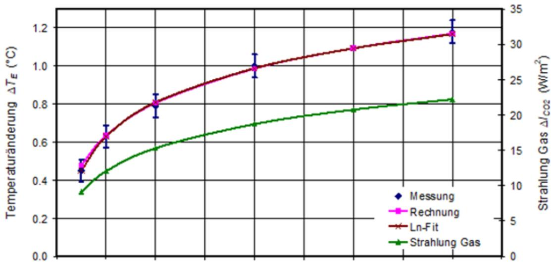
Abb. 5: a) Gemessene Temperaturänderung der Erdplatte als Funktion der CO<sub>2</sub>-Konzentration (Blaue Rauten) und Rechnung (Magenta Quadrate) mit logarithmischem Fit (Braune Kreuze). ST-Rechnung der Rückstrahlung  $\Delta I_{CO_2}$  (Grün).
