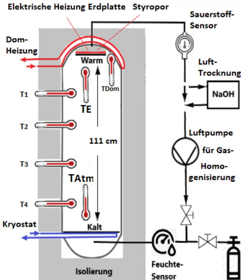
Abb. 1: Versuchsanordnung für die Messung mit Treibhausgasen.
