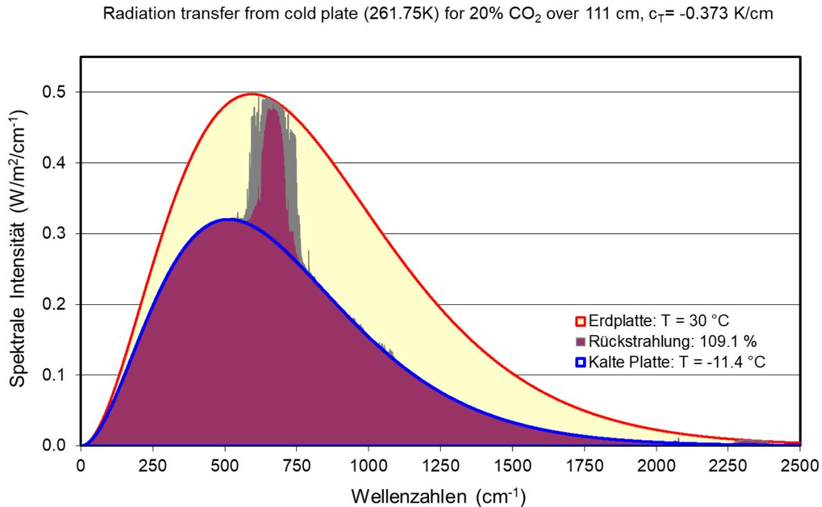
Abb. 3: Strahlungs-Transfer-Rechnung für 20 % CO<sub>2</sub> in Luft über 111 cm für einen Temperaturanstieg von 0,373 °C/cm: Rückstrahlung von Atmosphärenplatte und Gas (Dunkelrot und Grau), Strahlung nur von Atmosphärenplatte (Blaue Linie) und spektrale Intensität der Erdplatte (Rot-Gelb).
