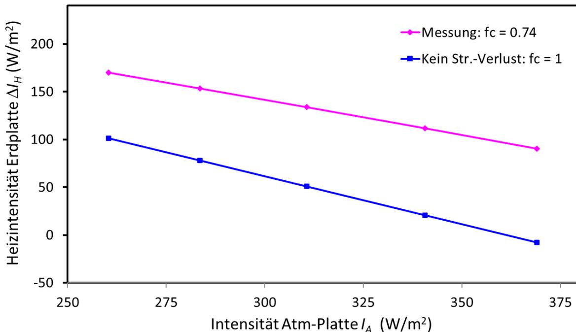
Abb. 4: Gemessene Heizintensität der Erdplatte für eine feste Temperatur  $T_E = 30 \text{ °C}$  als Funktion der Strahlungsintensität  $I_A$  der Atm-Platte (Magenta Rhomben). Ebenfalls aufgetragen ist die theoretische Heizintensität für 100 %-ge Strahlungsübertragung (Blaue Quadrate).
