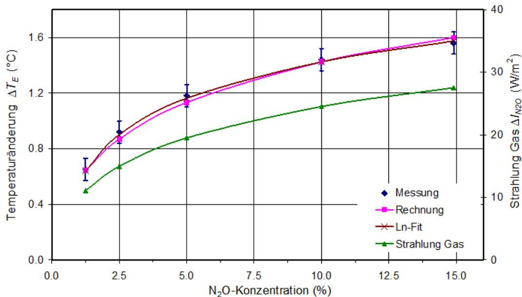
Abb. 7: Gemessene Temperaturänderung der Erdplatte als Funktion der N<sub>2</sub>O-Konzentration in trockener Luft (Blaue Rauten) und entsprechende Berechnung (Magenta). Überlagert ist ein logarithmischer Fit (Braun) und die ST-Rechnung der rückgestrahlten Intensität ΔI<sub>N2O</sub> (Grün).
