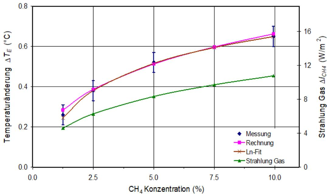
Abb. 6: Gemessene Temperaturänderung der Erdplatte als Funktion der CH<sub>4</sub>-Konzentration in trockener Luft (Blaue Rauten) und entsprechende Berechnung (Magenta). Überlagert ist ein logarithmischer Fit (Braun) und die ST-Rechnung der rückgestrahlten Intensität  $\Delta I_{CH_4}$  (Grün).
