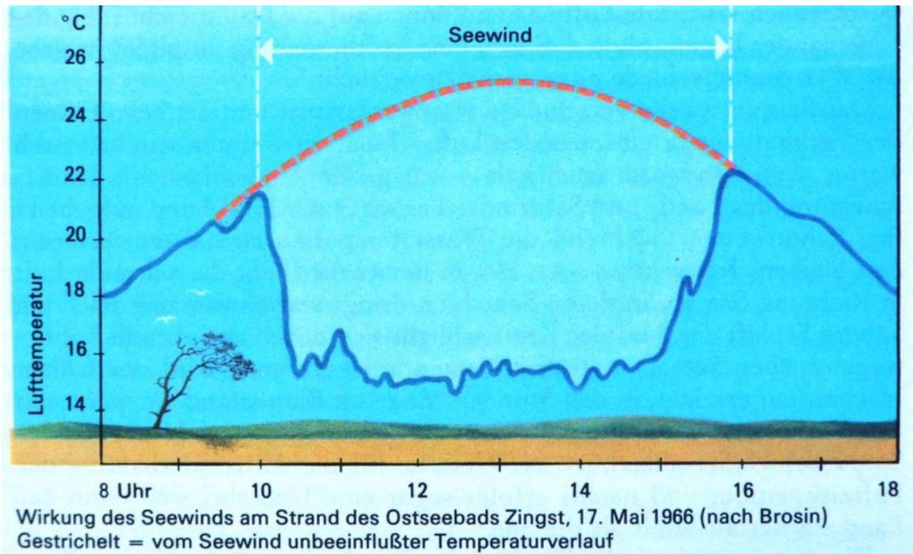
Abbildung 2: In dieser Grafik ist nicht die Windstärke, sondern der Gang der Lufttemperatur an der Ostseeküste an einem sonnigen, von Hochdruckwetter beeinflussten Frühlingsmorgens gezeigt. Nur während der Seewind-Phase, die in diesem Beispiel von etwa 10 bis 16 Uhr Normalzeit dauerte, steht ausreichend Wind zur Stromerzeugung zur Verfügung. Der Seewind gibt sich durch seine Kühlwirkung zu erkennen; er verursachte am Vormittag einen Temperatursturz von etwa 6 Grad.
