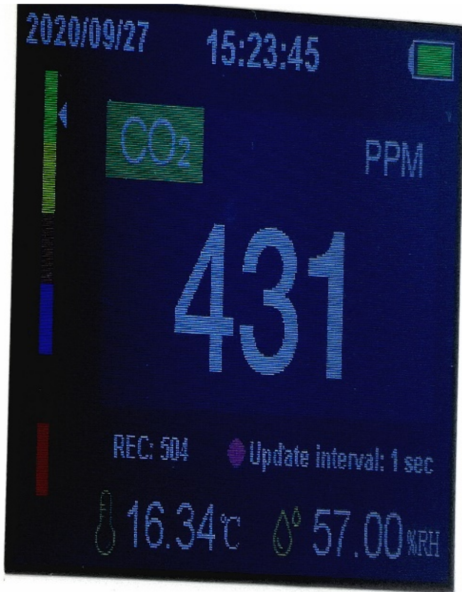
Bild 6 -11: Nach 15:23:45 langsames, gleichmäßiges Einleiten von CO 2 mit Schlauch in den Kasten Bild 11
