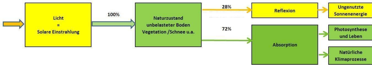
Energieflussbild unbelasteter Boden - vor Errichtung der PVA
