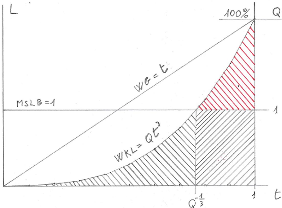
Die mit „MSLB“ gekennzeichnete horizontale Gerade stellt den mittleren Stromleistungsbedarf dar (auf den Wert 1 normiert).
