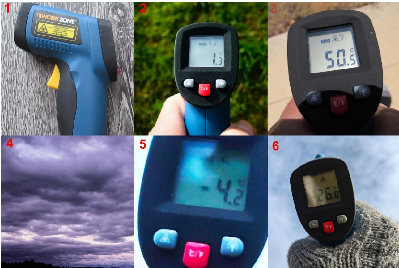
Abb. 5. Mit modernen Infrarot-Oberflächenthermometern (1), die in Baumärkten erhältlich sind, kann man leicht die Oberflächentemperatur des Bodens und der Wolkenbasis messen. (2)=Bodentemperatur 13. Januar th , 2013, (4)=Wolkendecke über dem Boden und (5)=der zugehörige Temperaturwert
