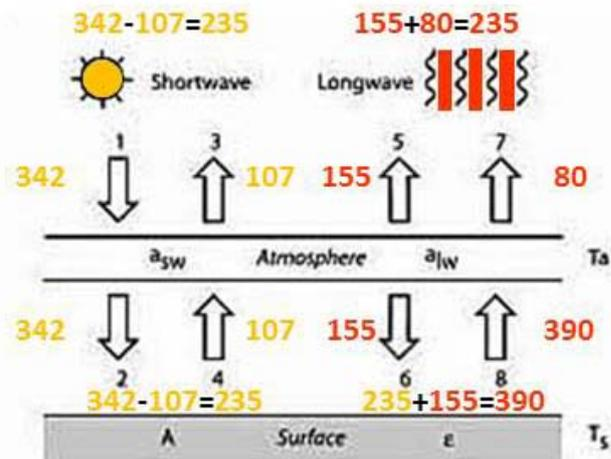
Abbildung 3.35: Block-Diagramm für die Strahlungskopplung einer einschichtige isothermen Atmosphäre und dem Erdboden mit spez. Strahlungsleistungen in  $[\text{W}/\text{m}^2]$
