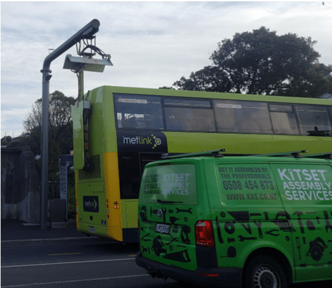
Doppeldecker-Elektrobus mit Stromabnehmer-Aufladung
