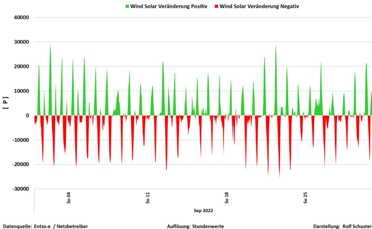
Abb. 2 Die Grafik zeigt die schnellen Änderungen der Einspeisung von Wind & Solar aus Abb 1. oben, im Berichtszeitraum als evtl. Auslöser von Abschaltungen (Blackout, Brownout)
