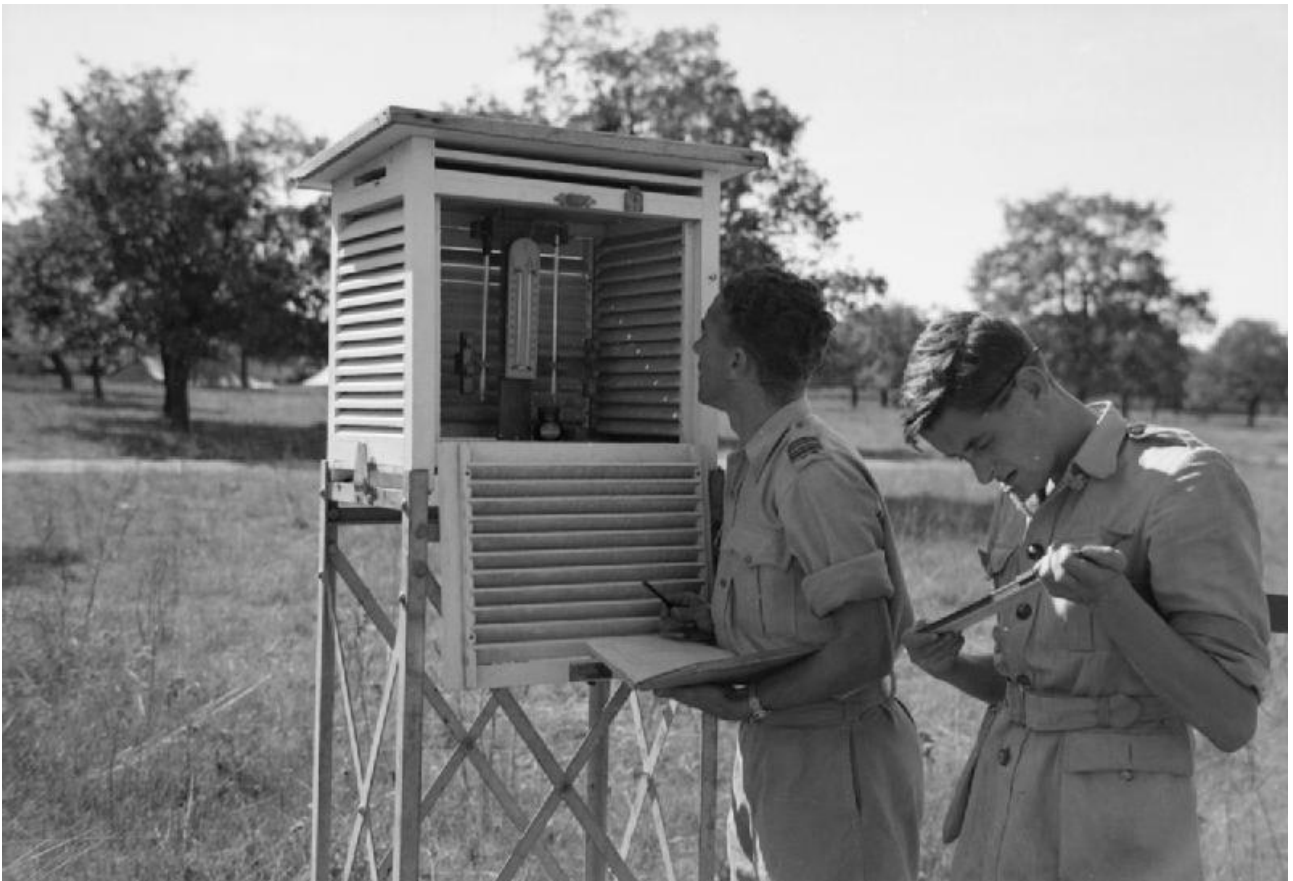
Abb.24, Quelle , zeigt das Ablesen der gemessenen Temperatur in einer sog. Thermohütte.
