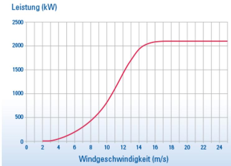
Abbildung 19: Leistungskennlinie einer großen Windturbine. Erst ab 2,5 bis 3 m/s Windgeschwindigkeit überhaupt Stromerzeugung, welche dann bis zur Nennleistung, die bei etwa 12 bis 14 m/s erreicht wird, mit der dritten Potenz der Windgeschwindigkeit wächst („kubisches Gesetz“). [Bildquelle](#)
