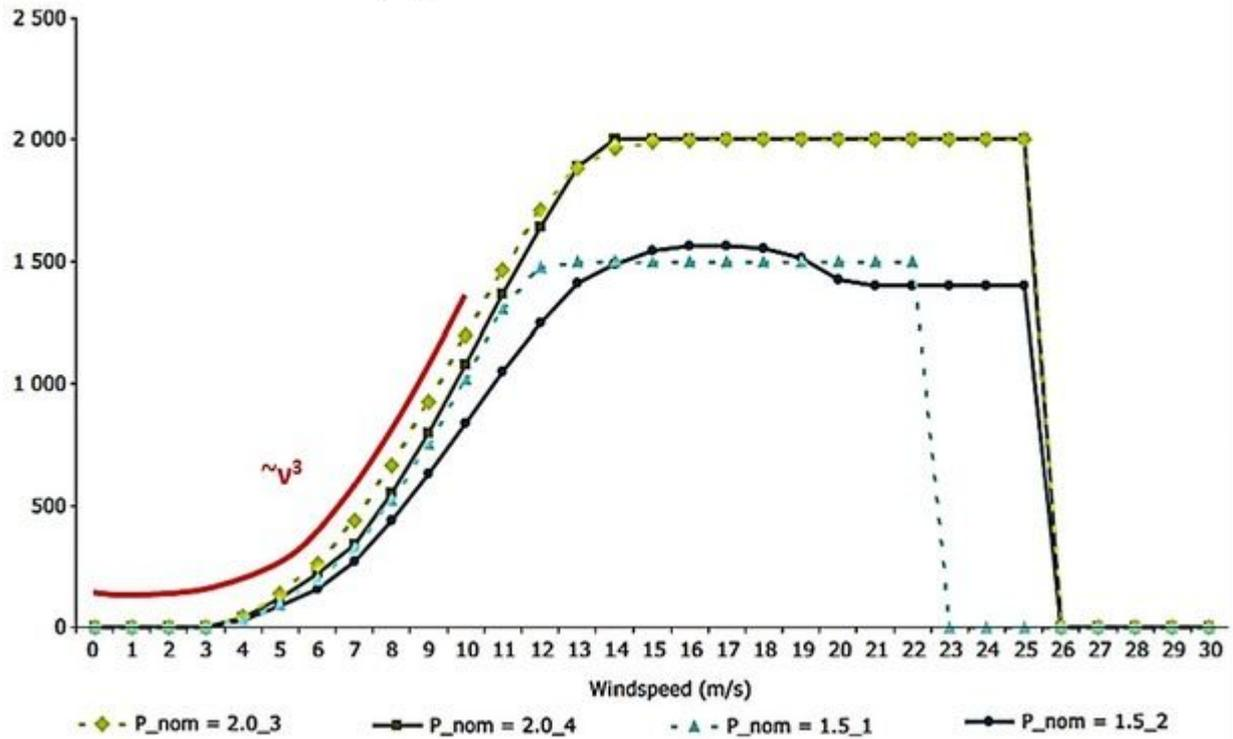
Leistungs-Geschwindigkeits-Kurven von vier bestehenden Windkraftanlagen.
