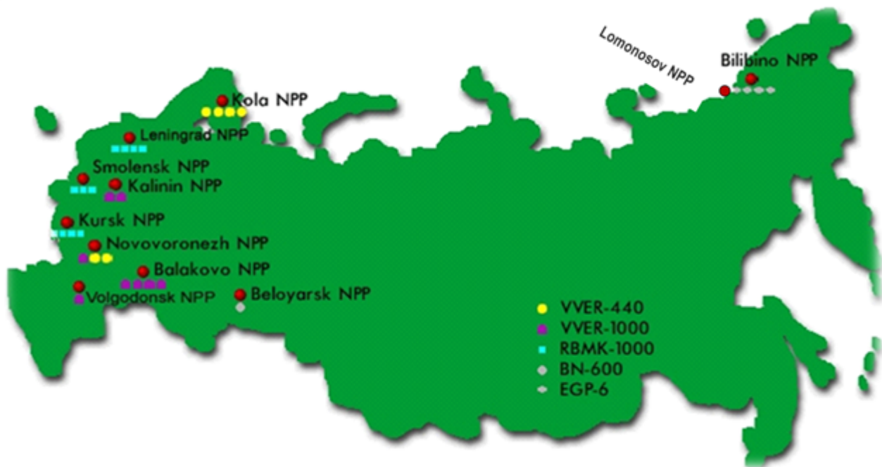
Bild 2. Kernkraftwerke in der Russischen Föderation. In 11 KKW's laufen insgesamt 38 Reaktoren mit einer Gesamtkapazität von 30.3 GW (Grafik: IAEA 3))
