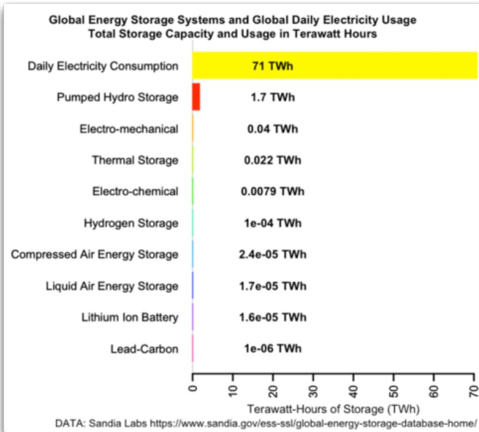
Abbildung 4. Globales Energiespeichersystem im Vergleich zum globalen täglichen Stromverbrauch.
