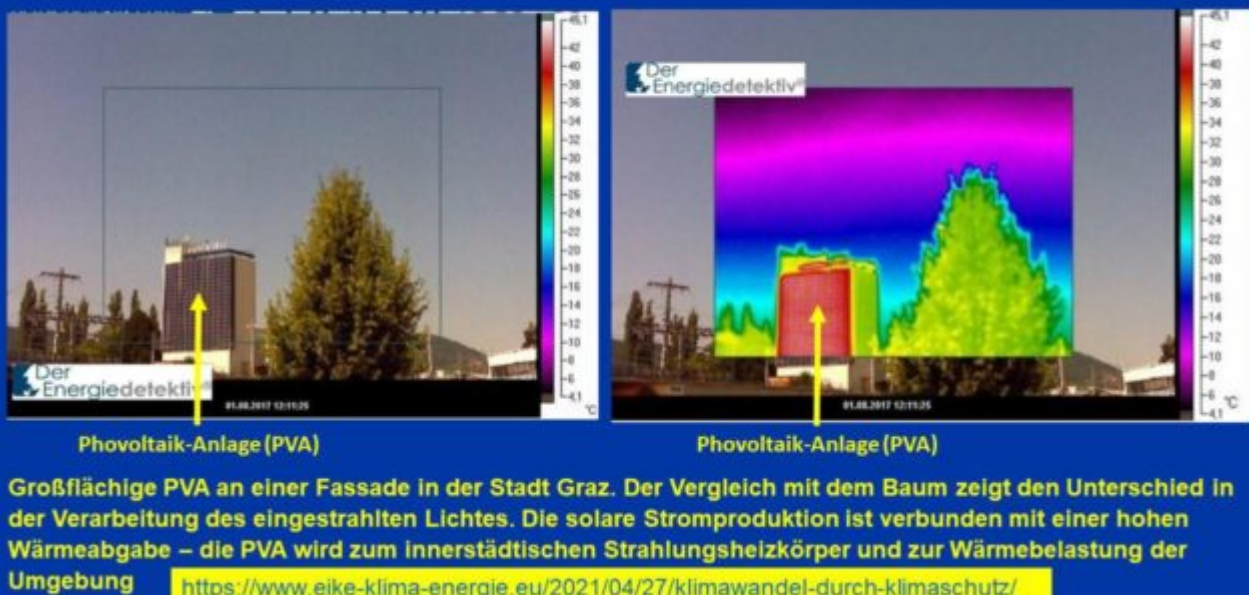
Abbildung 3: Photovoltaik-Anlagen werden zu innerstädtischen Strahlungsheizkörpern
