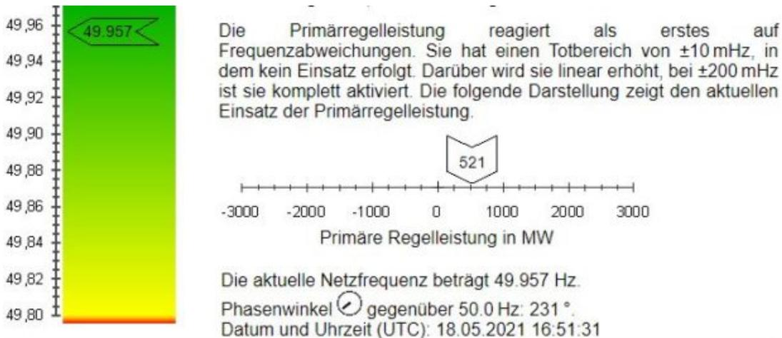
Die derzeit Primärregelleistung beträgt im obigen Screenshot gerade 521 MW, d.h., dass müssen konventionelle Kraftwerke gerade zusätzlich abgeben. Wind und Sonne können „kein Gas geben“.
