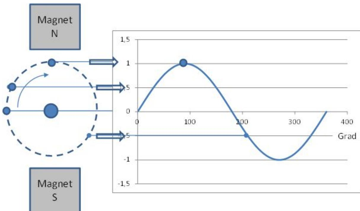
Es ist egal, ob die Leiterschleife oder der Magnet bewegt wird – die induzierte Spannung und damit der Strom, pulsiert sinusförmig.
