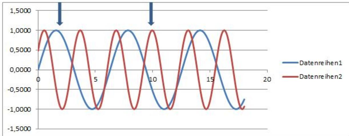
Um es deutlich darzustellen, sehen Sie im obigen Beispiel einen Frequenzunterschied von 1:2. Und auch eine Phasenverschiebung. An vielen Stellen ist der Wert (die Spannung) der beiden Sinuswellen sehr unterschiedlich, im realen Netz kommt zu Ausgleichsströmen.
