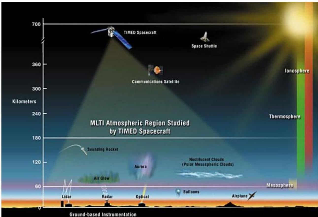
Die Aufgabe von SABER ist es, die Infrarot-Emissionen von Kohlendioxid (CO<sub>2</sub>) und Stickstoffmonoxid (NO) zu überwachen – durch die Messung des Infrarot-Glühens dieser Moleküle kann SABER den thermischen Zustand des Gases ganz oben in der Atmosphäre beurteilen: eine Schicht, die die Forscher „Thermosphäre“ nennen.
