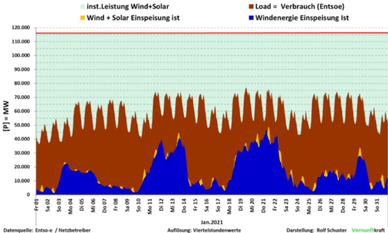
Wind- und Solareinspeisung gegenüber Verbrauch und installierter Leistung im Januar 2021. Installierte Leistung ca. 116 GW. Daten Entsoe; Grafik Ralf Schuster Vernunftkraft
