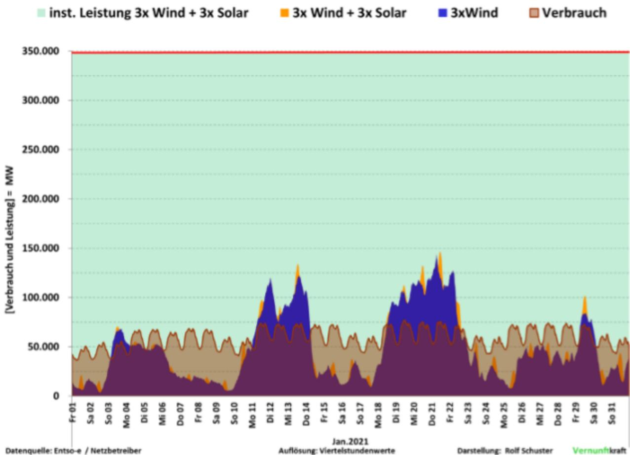
Simulierte Wind- und Solareinspeisung gegenüber Verbrauch und 3 fach installierter Leistung im Januar 2021. Installierte Leistung ca. 350 GW. Daten Entso-e; Grafik Ralf Schuster Vernunftkraft
