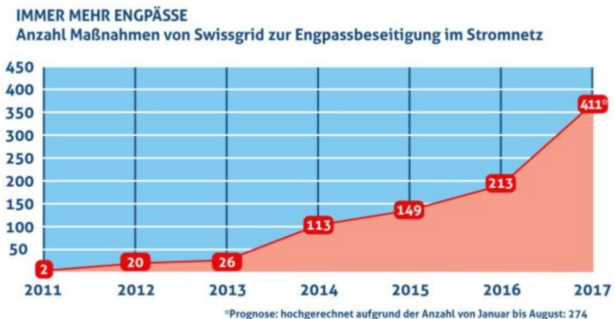
Bild 7: Entwicklung der Zahl von Redispatch-Maßnahmen im Schweizer Stromnetz, das ein Teil des Europäischen Verbundnetzes ist (Quelle: Swissgrid)
