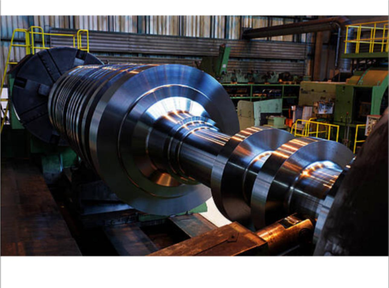
Bild 5: Die gewaltigen, mit 3.000 Umdrehungen pro Minute rotierenden Schwungmassen der Generatoren können innerhalb von Millisekunden einen Teil ihrer Rotationsenergie als elektrische Energie in das Netz einspeisen.
