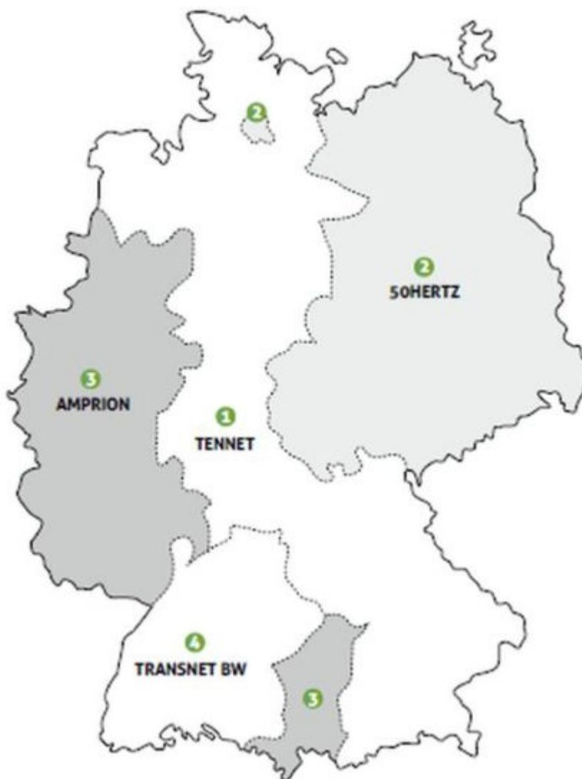
Bild 2: Die vier Regelzonen des deutschen Stromnetzes
