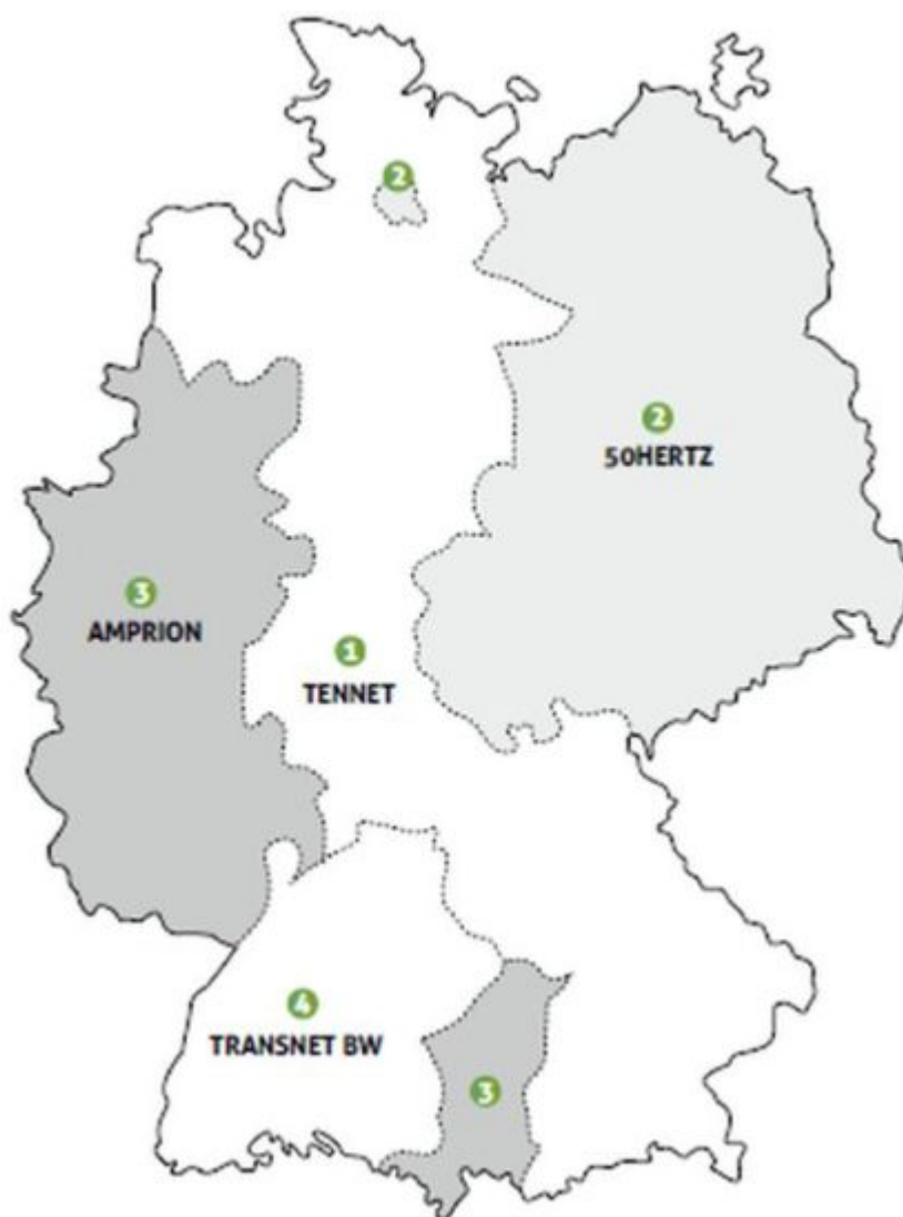
Bild 2: Die vier Regelzonen des deutschen Stromnetzes
