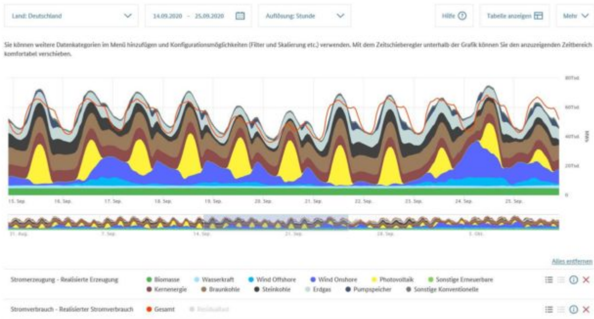
Abbildung 2: Realisierte Erzeugungsleistung und tatsächlicher Stromverbrauch im Zeitraum 14.-25. September 2020 (Quelle: SMARD)
