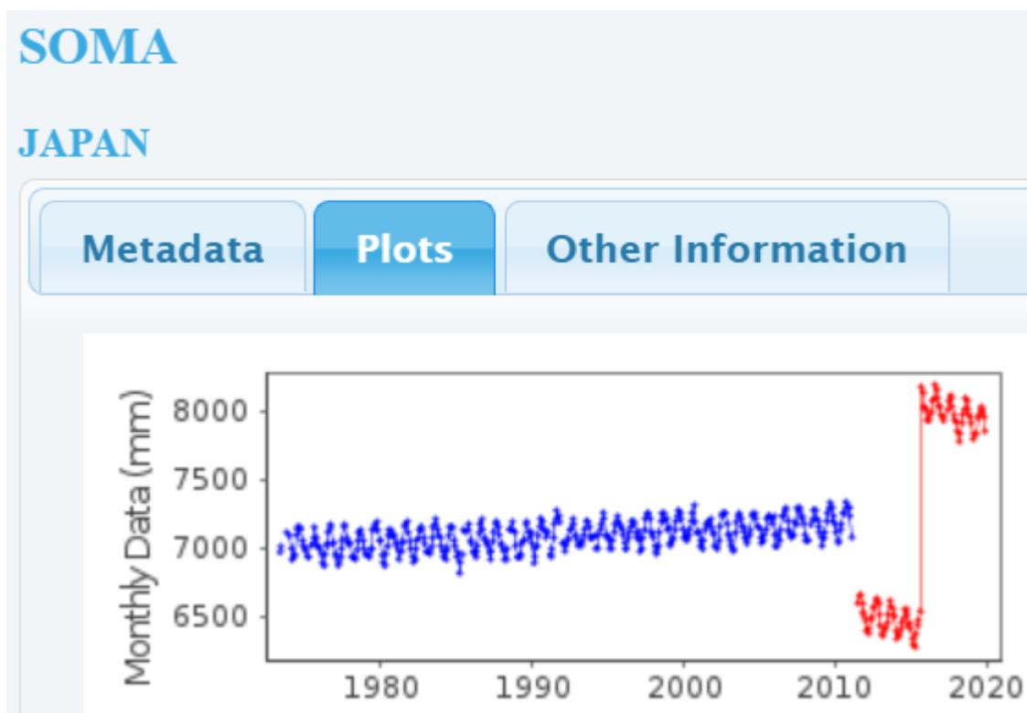
Bild 7 Beispiel von Erdbeben im Tidenpegelverlauf. Quelle:
