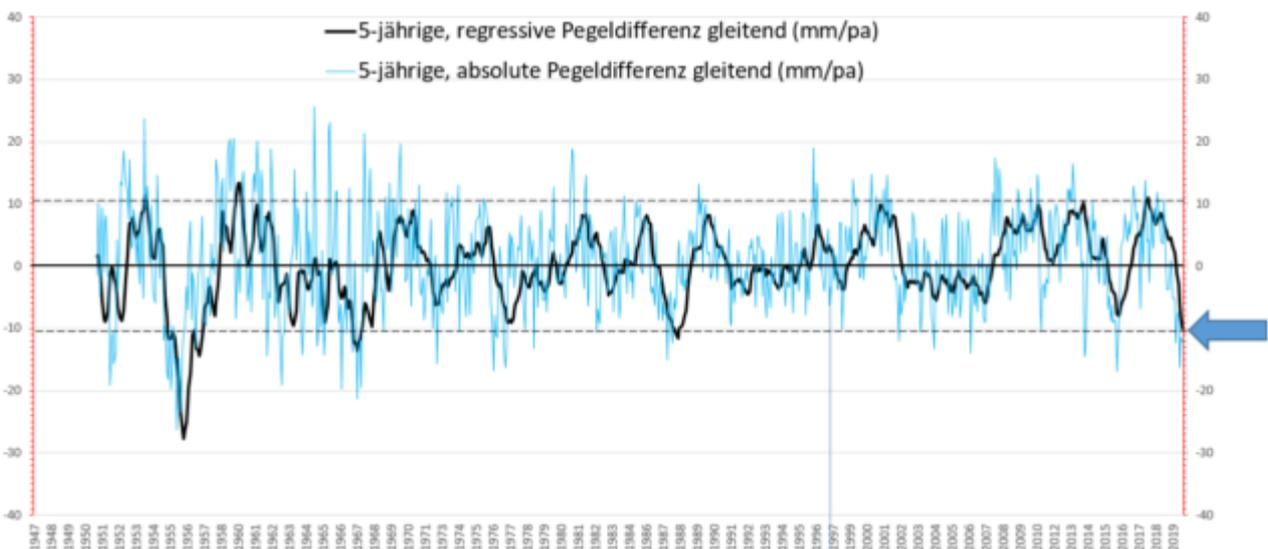
Bild 13 PSMSL-Datensätze Mittelwert: Pegel-Änderungsrate (Residuals) als Absolutwerte und als Steigungswerte der Regressionsgeraden von 1947 – 2019. Datenquelle: PSMSL. Grafik vom Autor erstellt
