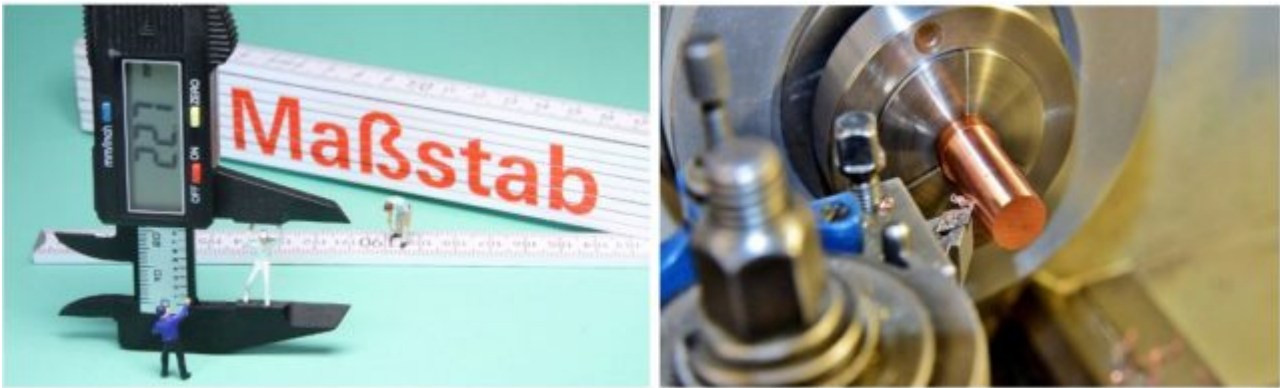
Abb 1: Links: Zollstock und digitaler Mess-Schieber. Unterschied der Genauigkeit Rechts: Bearbeitung einer Welle an einer Drehbank. Quelle: Jeweils Pixabay
