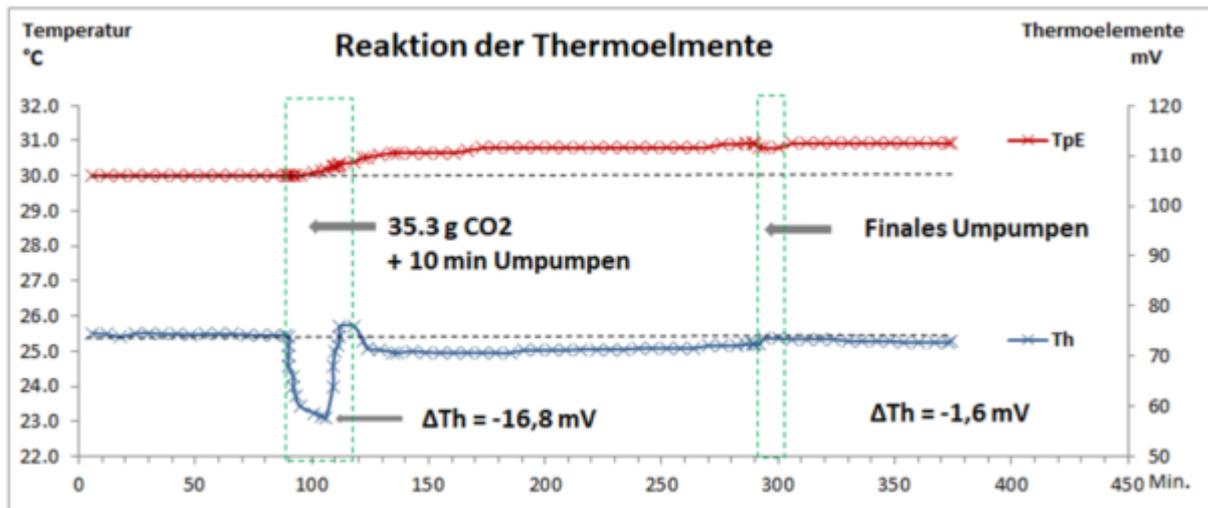
Abb. 2c: Temperaturanstieg der Erdplatte (rot) und Reaktion der Thermoelmente bei Einleiten und Diffusion von CO<sub>2</sub> (blau, rechte Ordinate).
