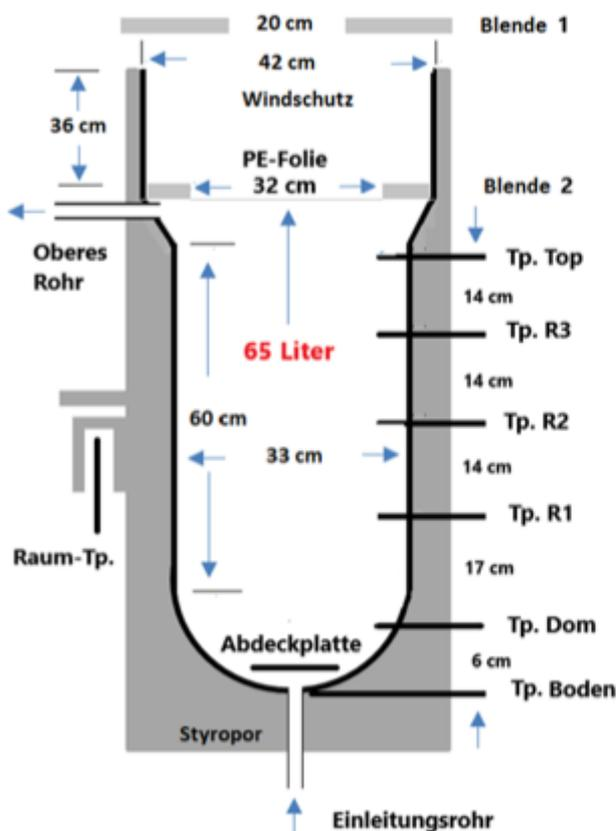
Alle Temperaturen werden mit Datenloggern im Minutentakt aufgezeichnet. Bis auf Tp. Boden messen alle Sensoren die Luft- bzw. Gastemperaturen.
