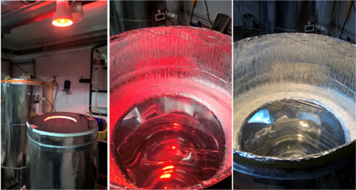
Abb. 2: Linkes Bild: Die Strahlungs-Apparatur mit Blende 1 Mitte und Rechts: Strahlungs-Apparatur mit Blende 2, mit rotem bzw. weißem Licht bestrahlt
