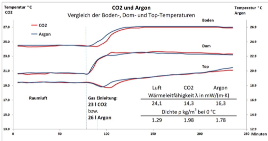
**Abb. 4: Vergleich der CO<sub>2</sub>- und der Argon-Temperatur-Anstiege**
