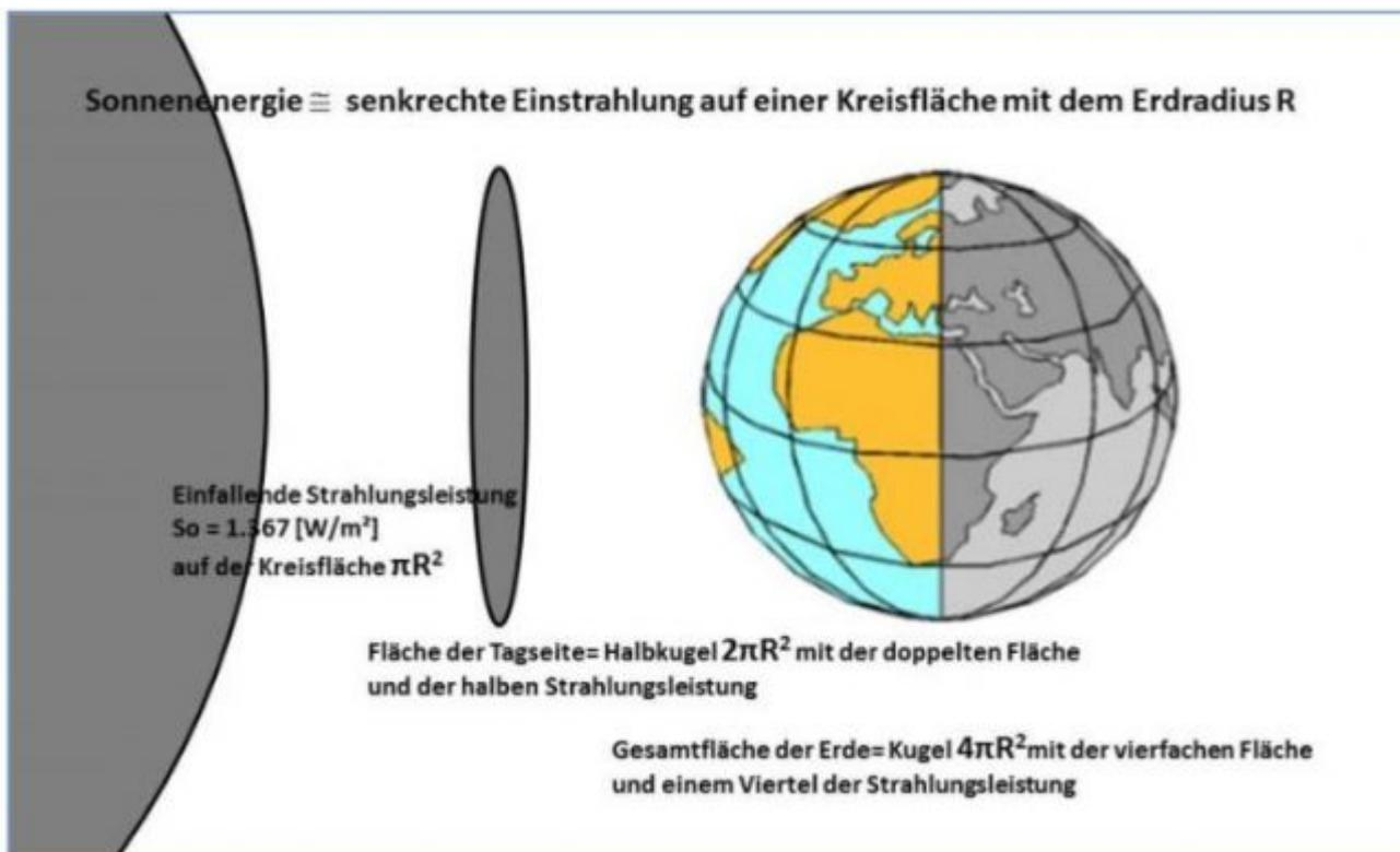
Abbildung: Flächenverhältnisse für die solare Einstrahlung auf der Erde
