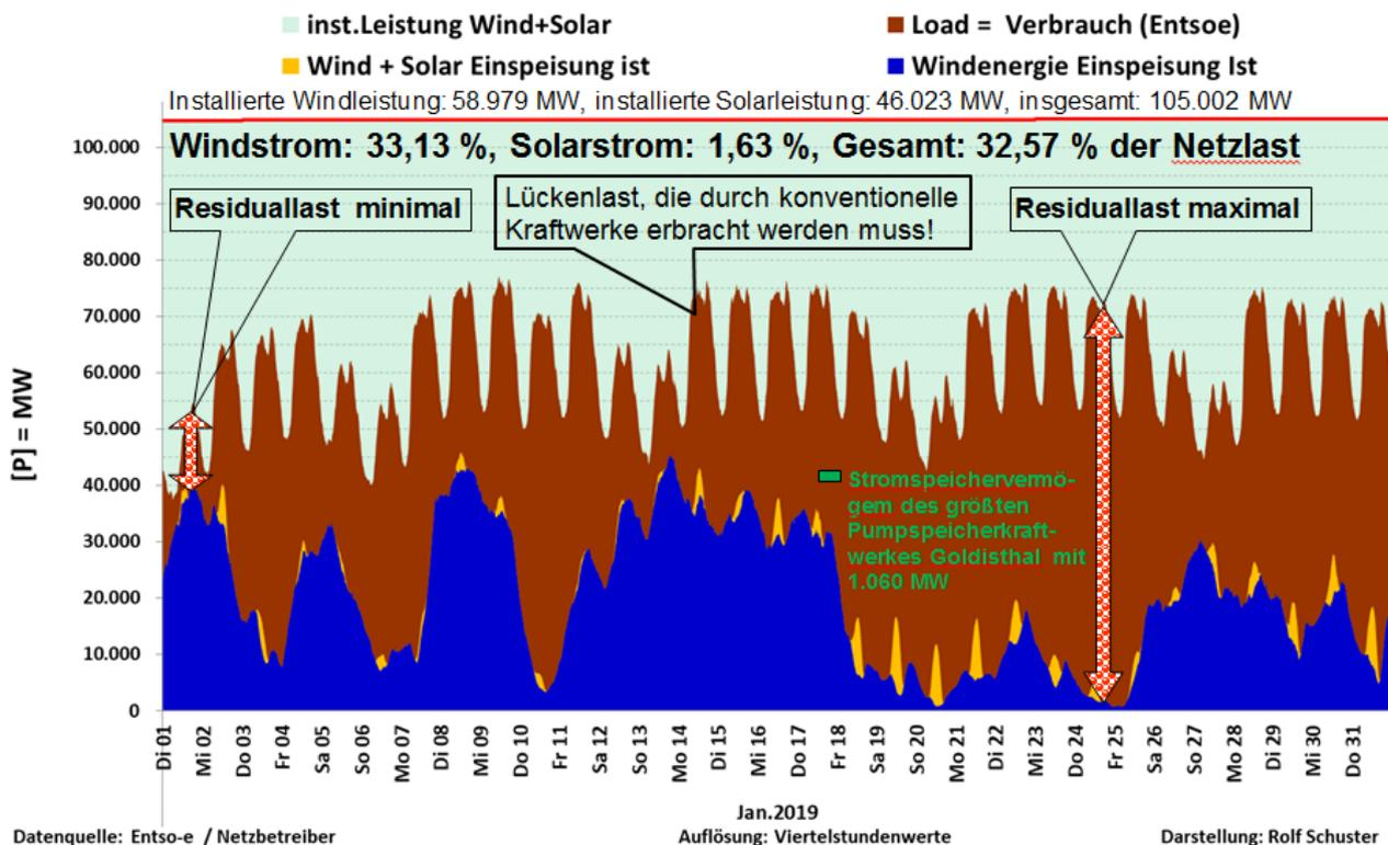
Das Diagramm mit seinen sogenannten Leistungsganglinien zeigt für jeden Tag des Januar den deutschen Strombedarf in Megawatt (MW) und womit er gedeckt wurde. Die braun gefärbte Fläche kennzeichnet den jeweils täglichen Gesamtbedarf und die Gesamterzeugung. Die blau gefärbte Fläche zeigt, mit wieviel Megawatt der Windstrom täglich zu Gesamtbedarf und
