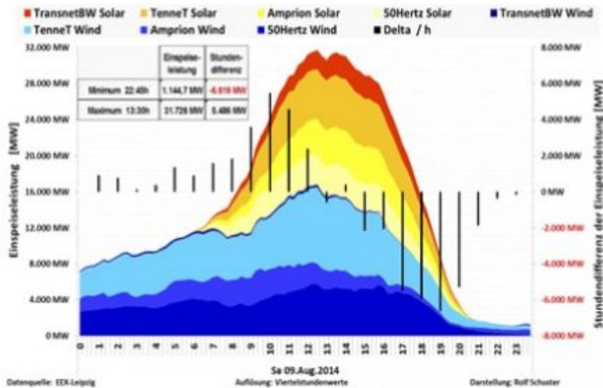
Bild 3: Mögliche Geschwindigkeiten des Stromabfalles über Wind+Sonne
