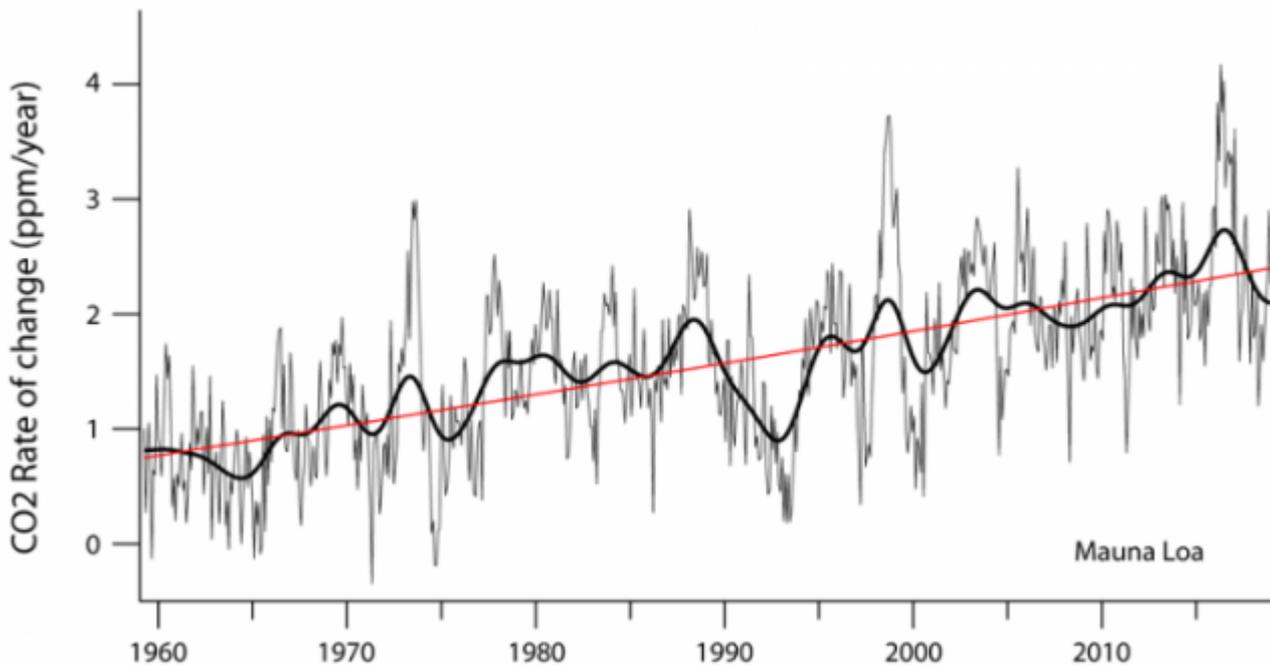
Abb. 2: Die am Mauna Loa gemessene Rate der Zunahme von CO<sub>2</sub> (ppm pro Jahr). Dünne Linie = 12-monatliche Zunahme, dicke Linie = Gauss'sche Glättung. Rote Linie = polynomisches Fit kleinster Quadrate 2. Ordnung der jährlichen Zunahme.
