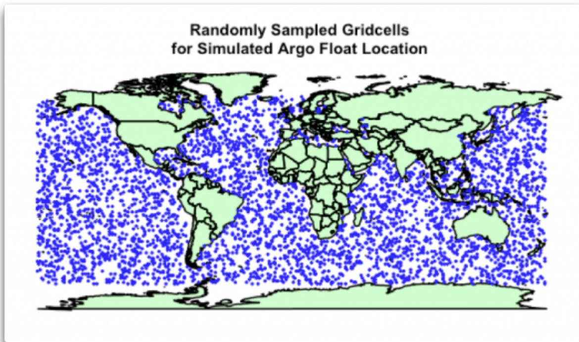
Abbildung 3: Typische simulierte Verteilung von ARGO-Bojen für einen Lauf einer Monte Carlo-Analyse.
