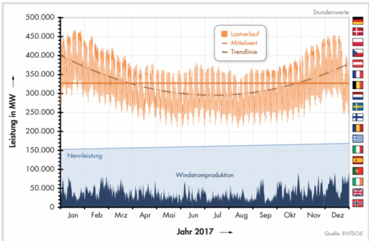
Bild 7. Windstromproduktion und Lastverlauf in 18 europäischen Ländern im Jahr 2017.
