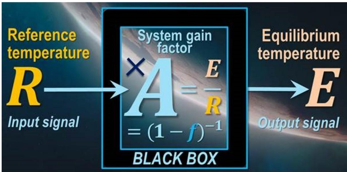
Das feedback-loop diagram vereinfacht sich zu diesem Black-Box Blockdiagramm.
