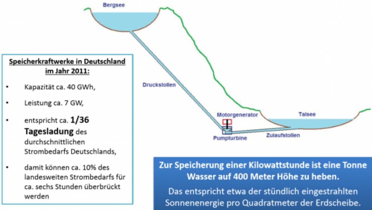
Bild 1 [2] Darstellung, welche geringe elektrische Speicherkapazität Pumpspeicher aufweisen (für 1 kWh Speichervermögen muss ein Kubikmeter Wasser 400 m hochgepumpt werden)
