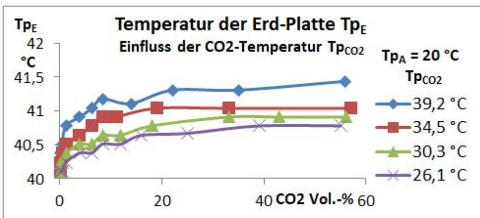
Abbildung 1: Erwärmung der 40°C warmen Erd-Platte nach Zugabe von CO<sub>2</sub> bei unterschiedlichen Lufttemperaturen  $T_{pCO_2}$
