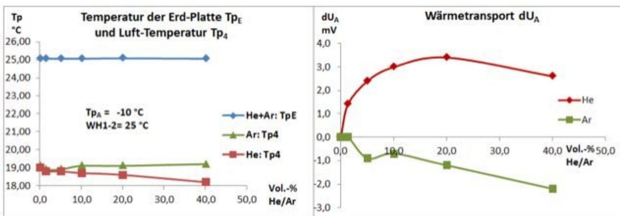
Abbildung 7: Temperatur- und Wärmetransport-Änderungen durch Helium und Argon.
